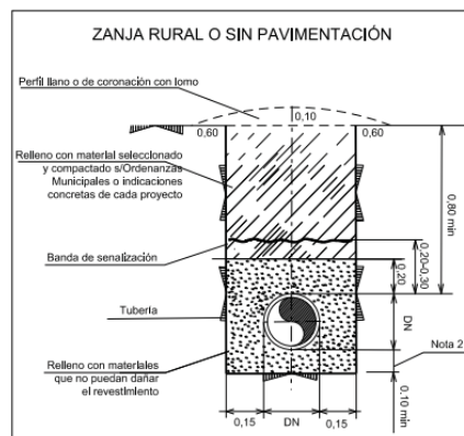
Ilustración 1. Detalle de sección transversal del gasoducto.
